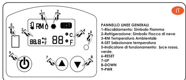
**QUESTA UNITÀ È DISEGNATA PER CONTROLLARE SISTEMI DI RAFFREDDAMENTO/RISCALDAMENTO SECONDO NECESSITÀ.**
