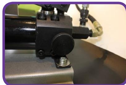
**Paso 3:** Mueva el mango hacia arriba y hacia abajo para aumentar / disminuir la presión.
