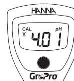
Use pH 4 o 10 para realizar una calibración de dos puntos. El valor se reconoce automáticamente y se muestra con el indicador de estabilidad parpadeante
