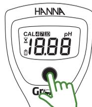
Presione el botón ON/OFF para encender el medidor. Se mostrarán todas las opciones de calibración.
