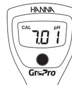
Si parpadea en pantalla la numeración "7.01", introduzca la punta de la sonda en una solución tampón de pH 4, 7, o 10 según corresponde.
